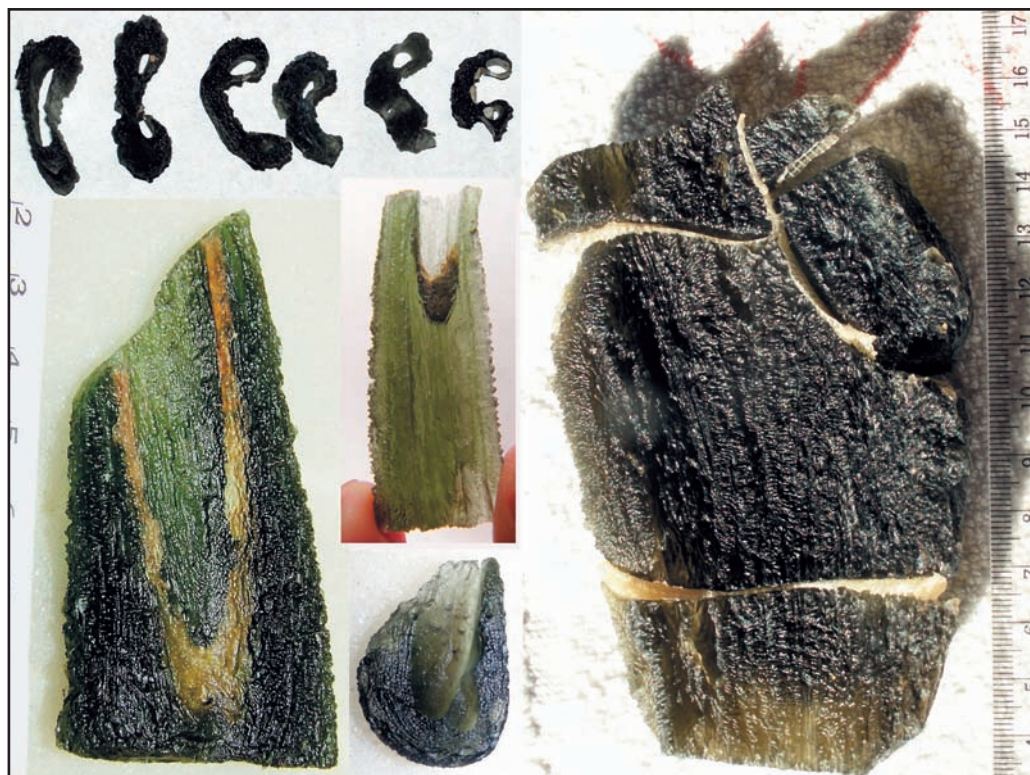
Obr. 6 – Zploštělé duté kapky; a) – smáčknutí stěn duté kapky v závislosti na síle stěny; b), c), d) – ploché – smáčklé úlomky stěn kapek s bublinou, e) – 130 g těžký zlomek stěny velké kapky s bublinou. Některé kapky mohly dosahovat HANUŠEM (1928) uvažovaných 500 g.
