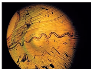
Obr. 20 – Vznik lechatelieritových meandrů při zahřátí na teplotu 1200°C.
