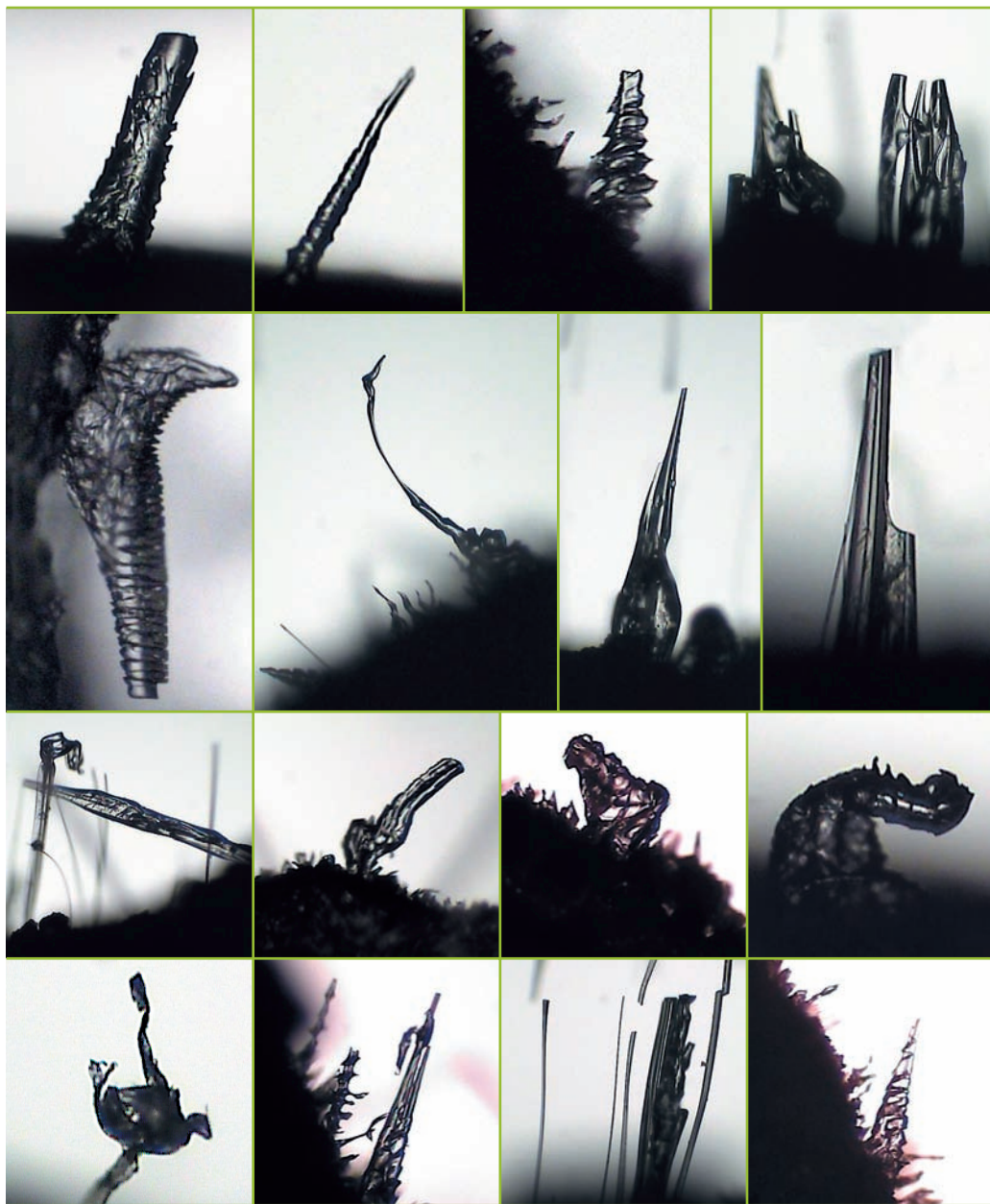
Tvary vyleptaných lechatelieritových uzavření ve vltavínech z Brusné a Besednice. Vyleptané lechatelieritové uzavření jsou nejlépe uchovány pro pozorování uvnitř brázd v „přetnutých“ vltavínech. Sběrka B. STAŇKA, foto P. RAJLICH.
